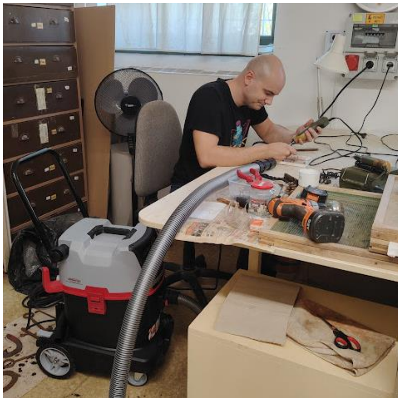
A mobil porelszívó használata a fém műhelyben (vaspor elszívása)
