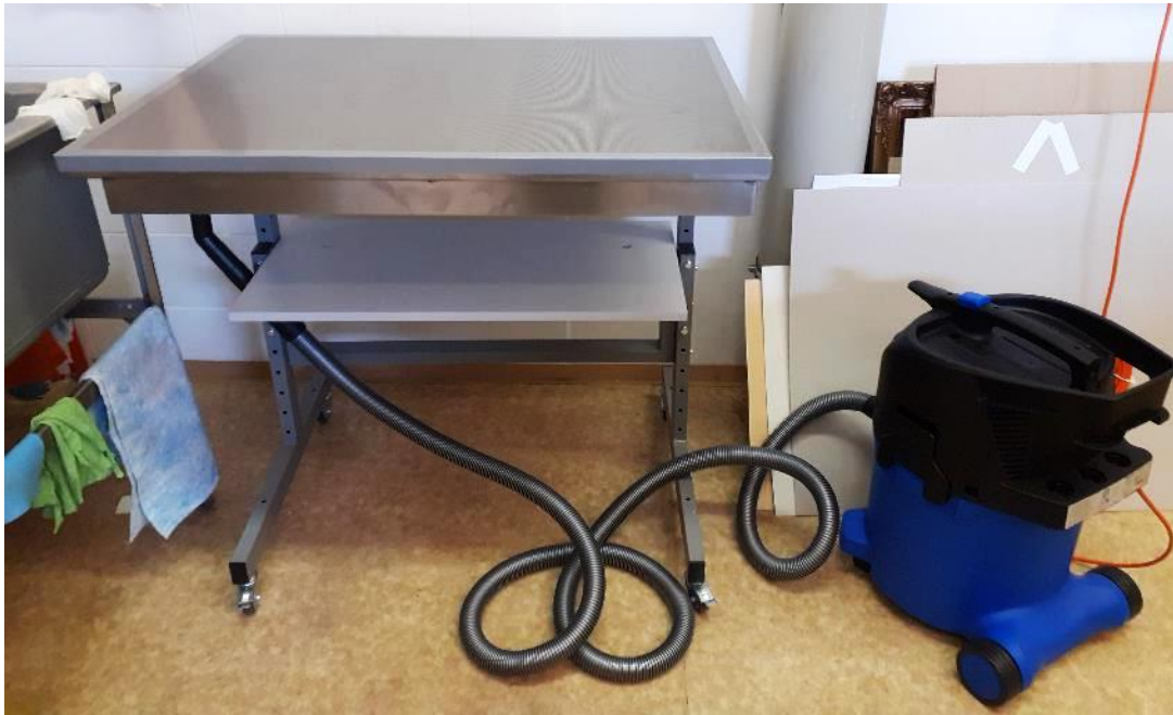
A kisnyomású fűrdőasztal az állványán, valamint a vizes porszívó
